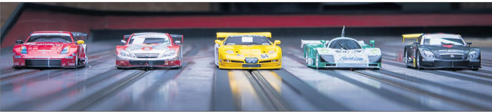
Slotcars am Start: Die Modelle entsprechen Rennwagen aus der „GT“- Klasse und der „Gruppe C“ und werden in Schlitzen (Slots) geführt, die im Vordergrund zu erkennen sind. Strom liefern Litzen entlang der Slots. Schleifer an der Unterseite der Wagen sorgen für Kontakt. Bilder: sus (6)
